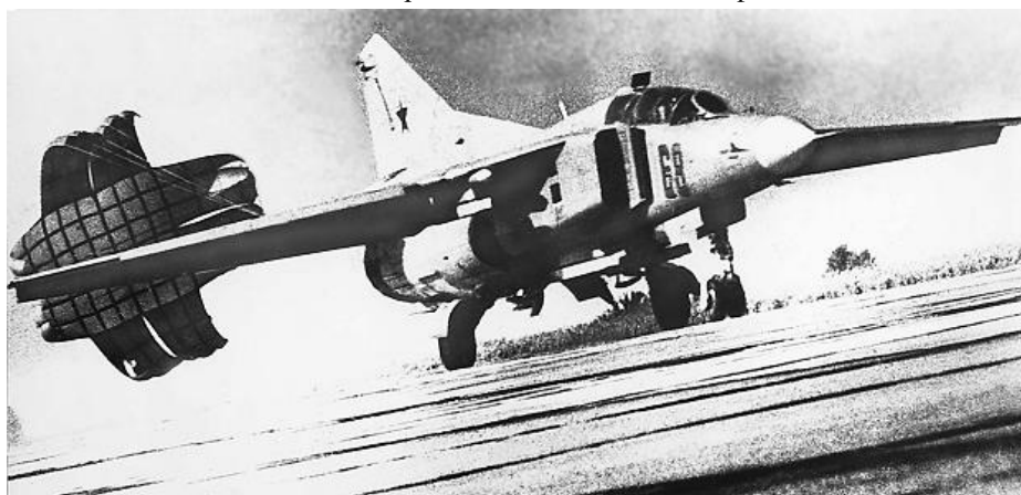
Рис. 8. Испытание крестообразного парашюта
