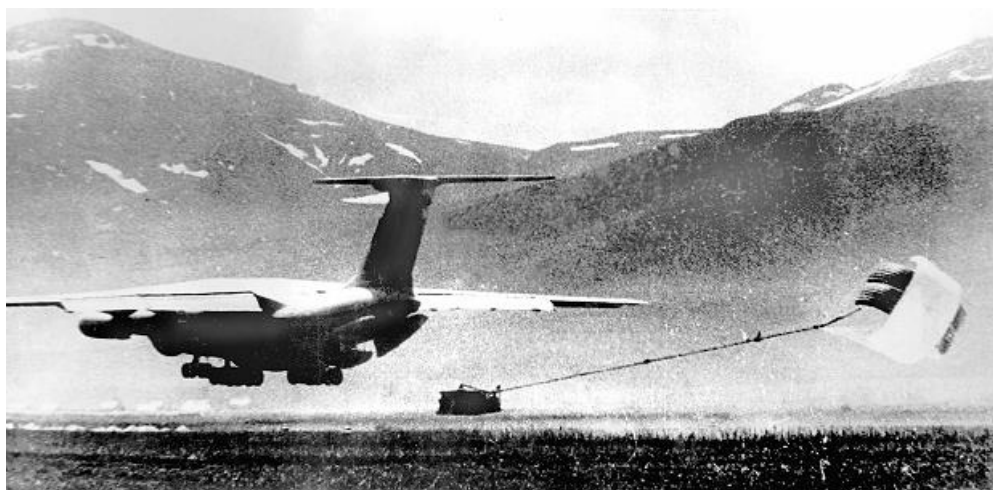
Рис. 9. Технология вытягивания тяжелых грузов из транспортных самолетов
