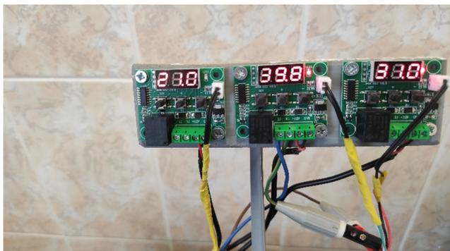
Рис. 8. Фотография термостатов экспериментальной установки
