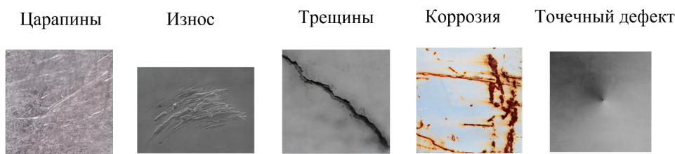
Рис. 2. Примеры наиболее распространённых типов дефектов УЭЦН
