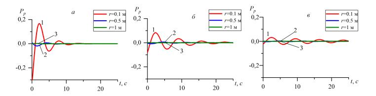
Рис. 2. Зависимости возмущения давления от времени для различных точек пласта: 1-r=0.1 м, 2-r=0.5 м, 3-r=1 м при значениях параметра проводимости трещины: a)  $C_f=5\cdot 10^{-13}$  м<sup>3</sup>, б)  $C_f=5\cdot 10^{-12}$  м<sup>3</sup>, в)  $C_f=5\cdot 10^{-11}$  м<sup>3</sup>
