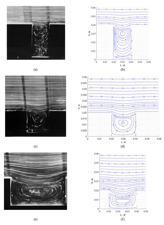
Рис. 3. Сравнение ползущего течения при обтекании прямоугольной каверны при числе  ${
