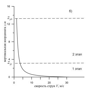
Рис. 2. Границы и осевая линия струи и шлейфа при отсутствии течения (a), зависимость скорости углеводородов от вертикальной координаты для первых двух этапов течения (б)
