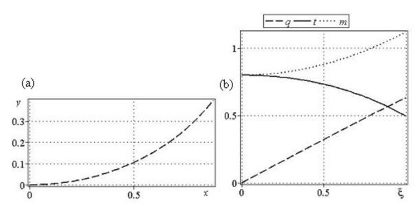
Рис. 2. Для параметров  $m_0=0.8,\,t_0=0.8$ : (а) форма поперечного сечения графена; (b) зависимости безразмерного усилия t, изгибающего момента m, перерезывающей силы q в графене от безразмерной дуговой абсциссы  $\xi$
