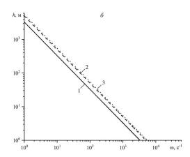
Рис. 2. Зависимости глубины проникания волны вертикальной поляризации в пористую среду от частоты для продольной (а) и поперечной (б) волн
