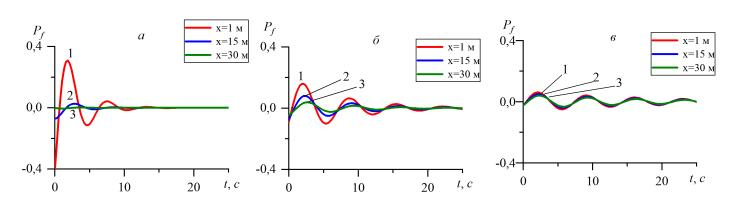
Рис. 3. Зависимость давления от времени в различных точках трещины ГРП: 1-x=1 м, 2-x=15 м, 3-x=30 м при значениях коэффициента проводимости трещины: а)  $C_f=5\cdot 10^{-13}$  м³, б)  $C_f=5\cdot 10^{-12}$  м³, в)  $C_f=5\cdot 10^{-11}$  м³
