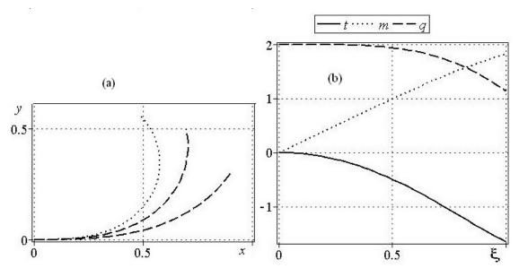
Рис. 3. Для параметров  $m_0=0,\,t_0=0$ : (a) формы поперечного сечения графена при различных  $q_0=6;4;2$  (пунктирная, штриховая, сплошная линии соответственно); (b) зависимости безразмерного усилия t, изгибающего момента m, перерезывающей силы q в графене от безразмерной дуговой абсциссы  $\xi$   $q_0=2$
