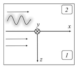
Рис. 1. Схема распространения волны на границе раздела сред
