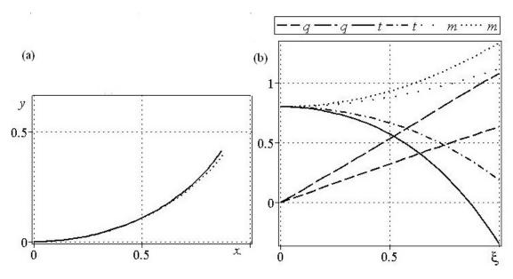
Рис. 4. Для параметров  $m_0=0.8$ ,  $t_0=0.8$ : (а) форма поперечного сечения графена для параметра  $\beta=0.5$ ; 0 (сплошная и пунктирные линии соответственно); (b) зависимости безразмерного усилия t, изгибающего момента m, перерезывающей силы q в графене от безразмерной дуговой абсциссы  $\xi$  для параметра  $\beta=0.5$  (сплошная, пунктирная, длинная штриховая линии соответственно) и  $\beta=0$  (штрихпунктирная, спецпунктирная, штриховая линии соответственно)
