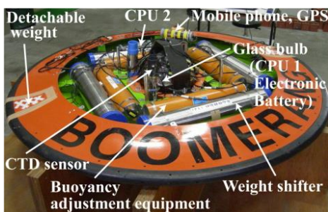
Рисунок 3 – Общий вид и схема системы управления движением глайдера
