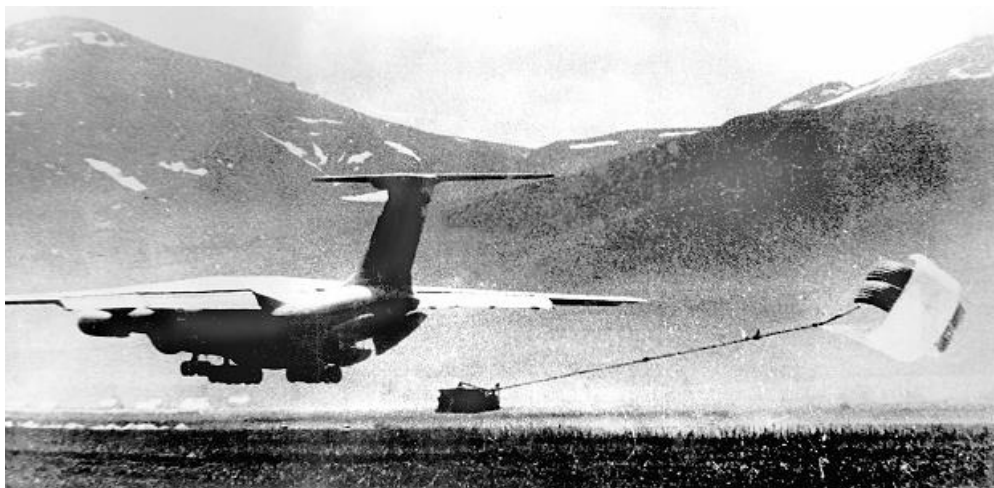
Рис. 9. Технология вытягивания тяжелых грузов из транспортных самолетов
