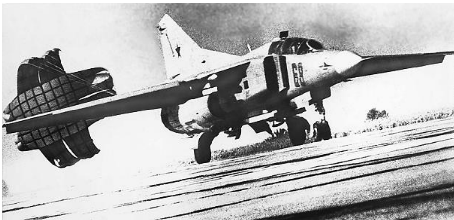
Рис. 8. Испытание крестообразного парашюта
