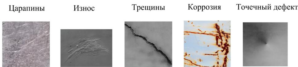
Рис. 2. Примеры наиболее распространённых типов дефектов УЭЦН
