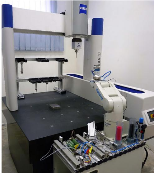
Рис. 5. Измерительная система на основе КИМ и манипулятора
