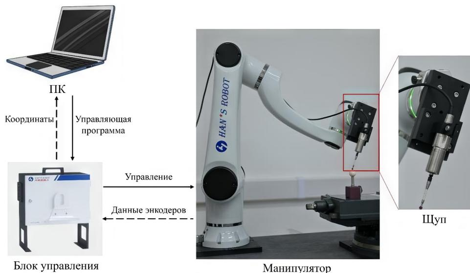
Рис. 3. Состав роботизированного измерительного модуля
