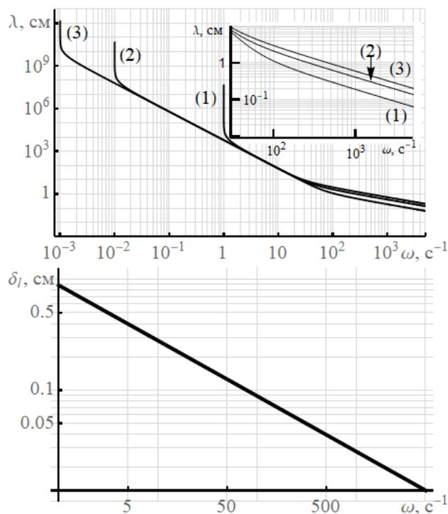
Рис. 1. Зависимость масштабов компонентов течения от частоты для воды: (а) – длины волны, линии (1 – 3) построены для  $N = 1; 0.01; 0.001 (c^{-1})$ ; (б) – толщины лигамента в сильно стратифицированной жидкости  $N = 1c^{-1}$
