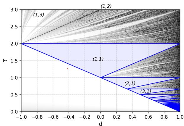
Рис. 2. Области существования волновых аттракторов, полученные методом трассировки лучей
