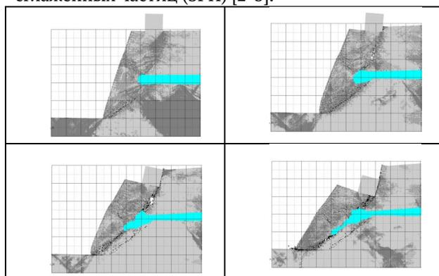
В численном анализе использовалась двумерная модель, включающая области с различными прочностными и фазовыми характеристиками. Рассчитанные результаты показывают структурные сдвиги и пиковые ускорения грунта при техногенных воздействиях. Кроме того, динамический отклик
