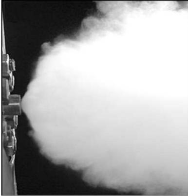
Рис. 1. Фотография поллой струи пара [2], истекающей через сопло диаметром 0.5 мм при начальной сверхкритической температуре  $T_0 = 650$  К
