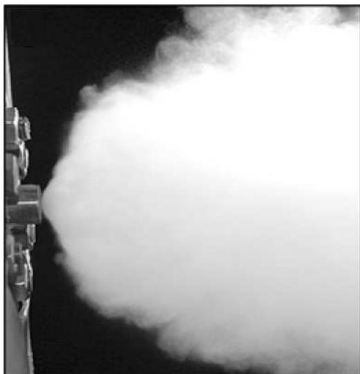
Рис. 1. Фотография струи пара [5], истекающей через сопло диаметром 0.5 мм при начальной сверхкритической температуре  $T_0 = 650$  К
