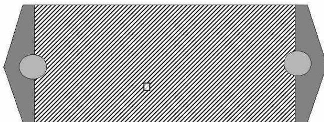
Рис. 1. Схема прозрачной плоской модели пористой среды. Размеры модели  $40 \times 20$  мм, глубина пор  $15$  мкм, диаметр входного и выходного отверстия  $2$  мм. Наблюдаемая под микроскопом область  $1 \times 0.8$  мм (показана прямоугольником)
