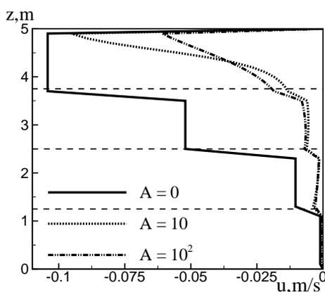
Рис. 2. Распределение скорости фильтрации в скважине по высоте
